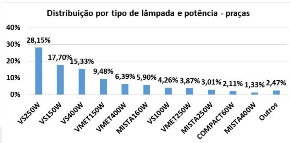
Figura 6: Distribuição de pontos luminosos por tipo e potência de lâmpada – praças.
