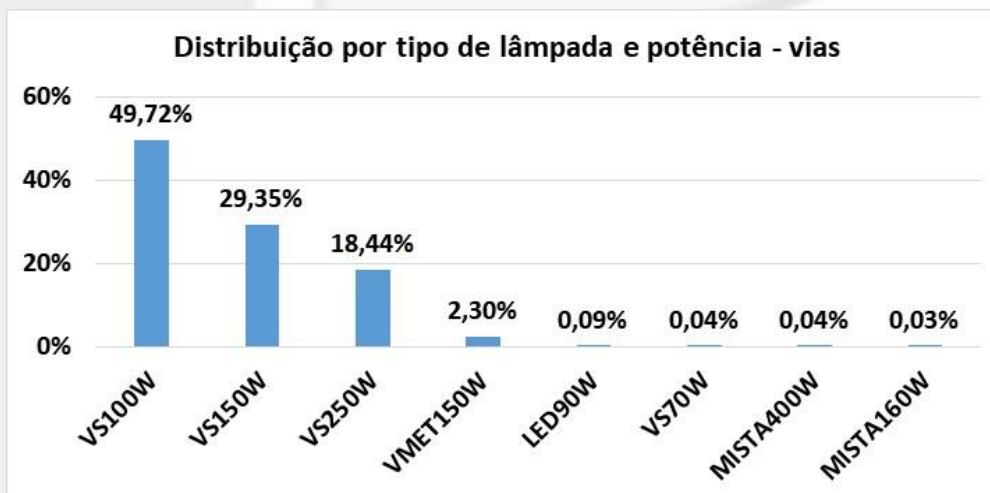
Figura 5: Distribuição de pontos luminosos por tipo e potência de lâmpada – vias.
