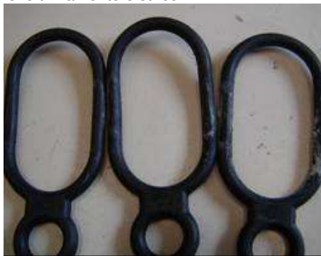
Figura 5: Anéis de amarração do fabricante D apresentando pequena deformação permanente e leve trilhamento elétrico.
