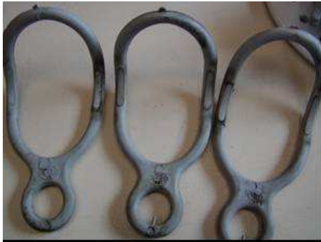
Figura 4: Anéis de amarração do fabricante B apresentando deformação permanente e trilhamento elétrico.
