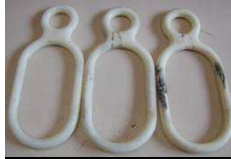
Figura 6: Anéis de amarração do fabricante C: nenhuma alteração significativa.
