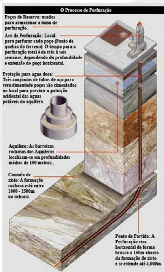
Figura 1: Técnica de perfuração vertical e horizontal para extração do gás de folhelho (Adaptado de [14]).
