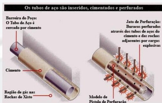
Figura 2: Processo de explosões controladas através da pistola de perfuração (Adaptado de [14]).
