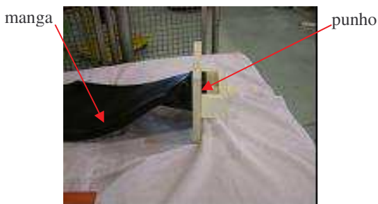
Figura 7: Manga com o sistema de vedação
