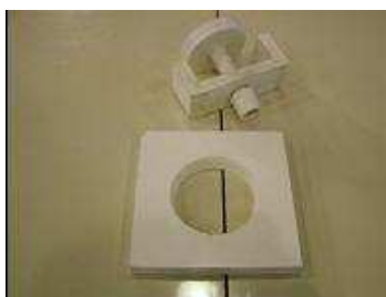
Figura 6: Vista do sistema de vedação de punho.
